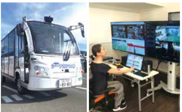
※自動運転レベル4とは、特定条件下で運転手が介在せずに、自動運転システムがすべての運転を行うことです。
