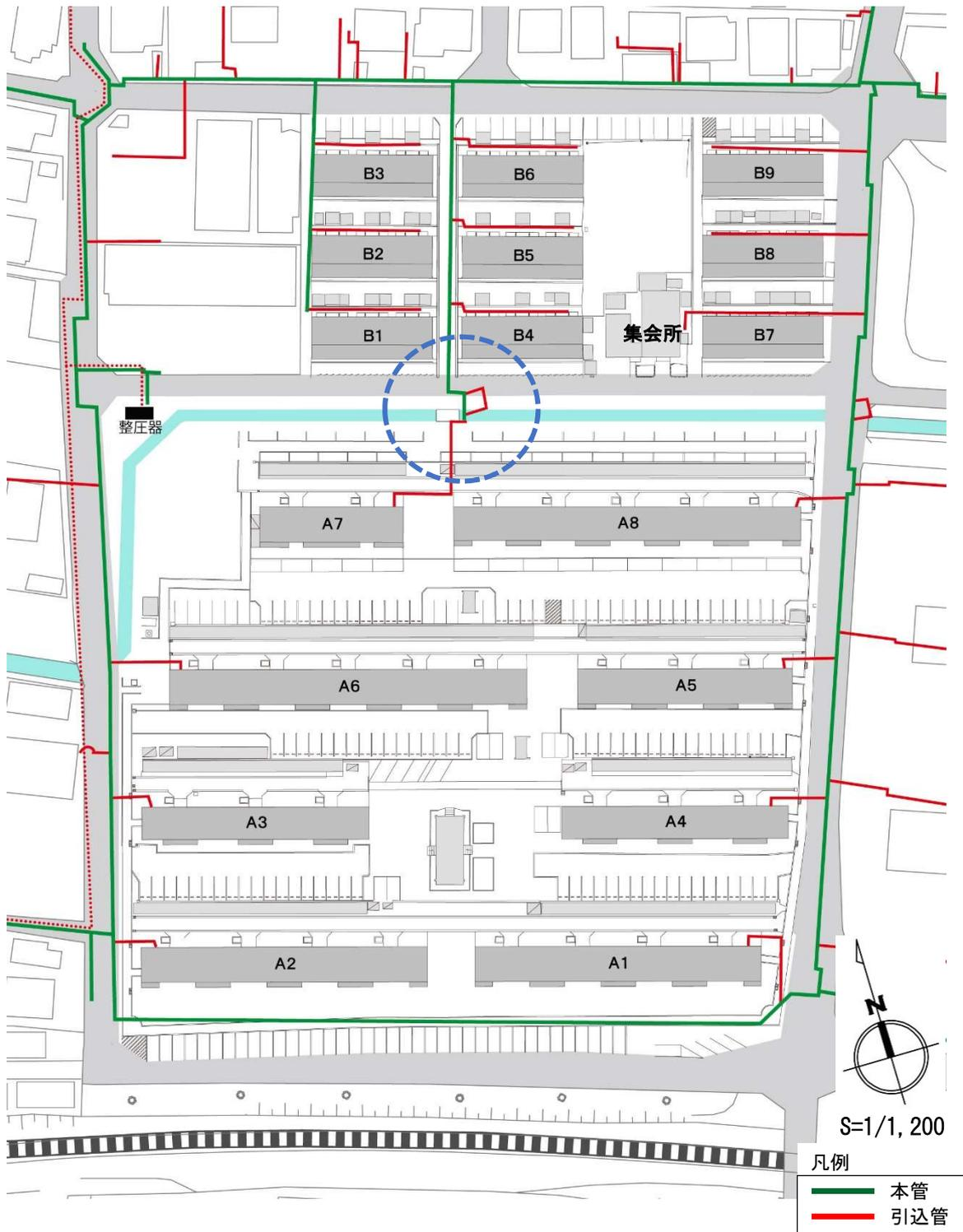
図2-5 : ガス管図
