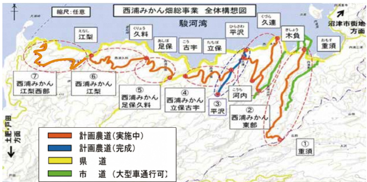
幹線農道 幅員4.5～5.5m 支線農道 幅員2.5～3.0m
