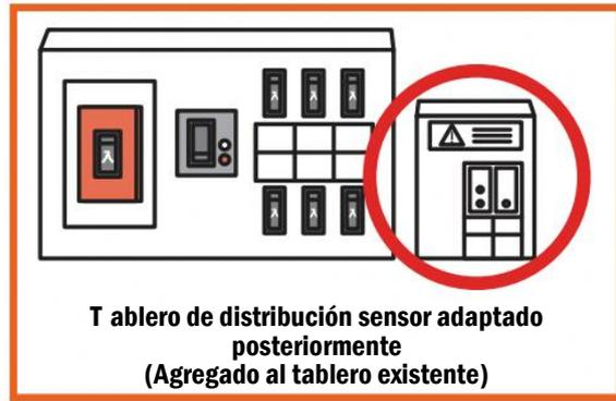
Los sensores de movimiento incorporados o adaptados al tablero de distribución de electricidad, cortan la electricidad cuando perciben el movimiento sísmico.
