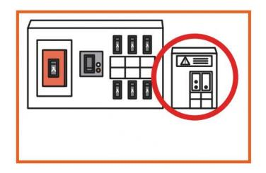
Sensores embutidos ou conectados ao quadro de distribuição detectam tremores de terremoto e desarmam o disjuntor para cortar a eletricidade.
