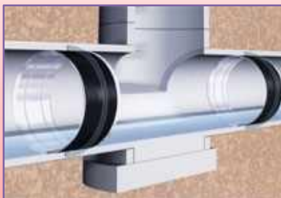
マンホールと管の継手の耐震化の一例
