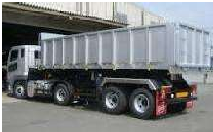
図 7.9 運搬車両（トレーラーダンプ）
