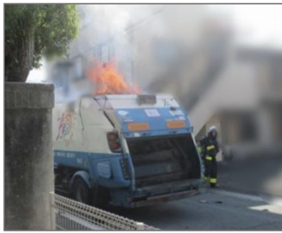
家電製品のバッテリーが原因で出火したごみ収集車 (令和5年10月)
